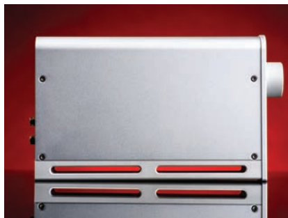
Lewy bok urządzenia stanowi wydrążony w środku bloczek aluminiowy - radiator.
