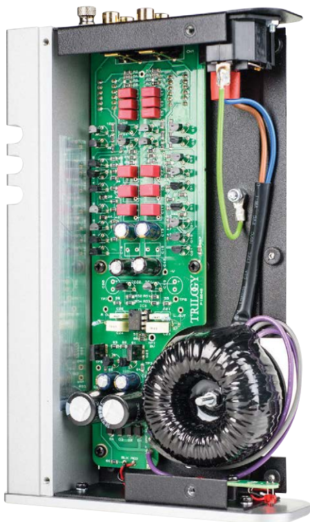
Wzmocnienie zapewniają tranzystory J-FET i bipolarnie BC55 (w konfiguracji asymetrycznej).
